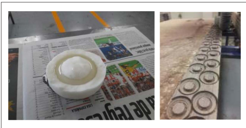
Figura 4. Molde de silicona para vaciado de resina (izquierda), corte CNC de bases de madera (derecha).
